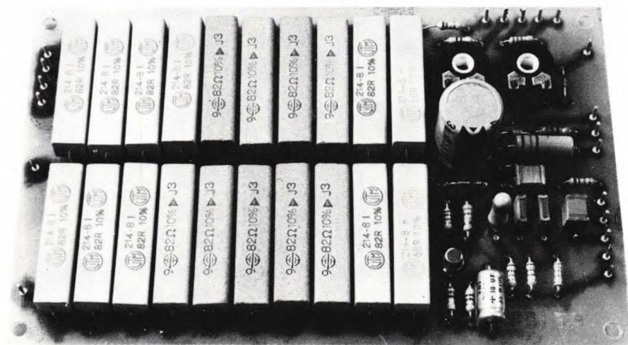
Afb. 10. De compleet gemonteerde print. De vermogensweerstand moeten minimaal 3 mm boven de print worden gemonteerd. Voor C7 is een elco genomen die geschikt moet zijn voor 'staande' montage.
